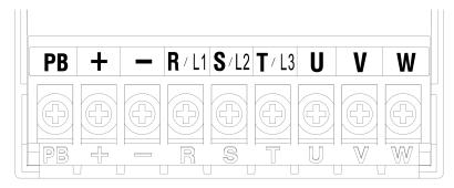
a) Schematic Diagram of Terminals (EM730-0R7-3B~EM730-1R5-3B)
